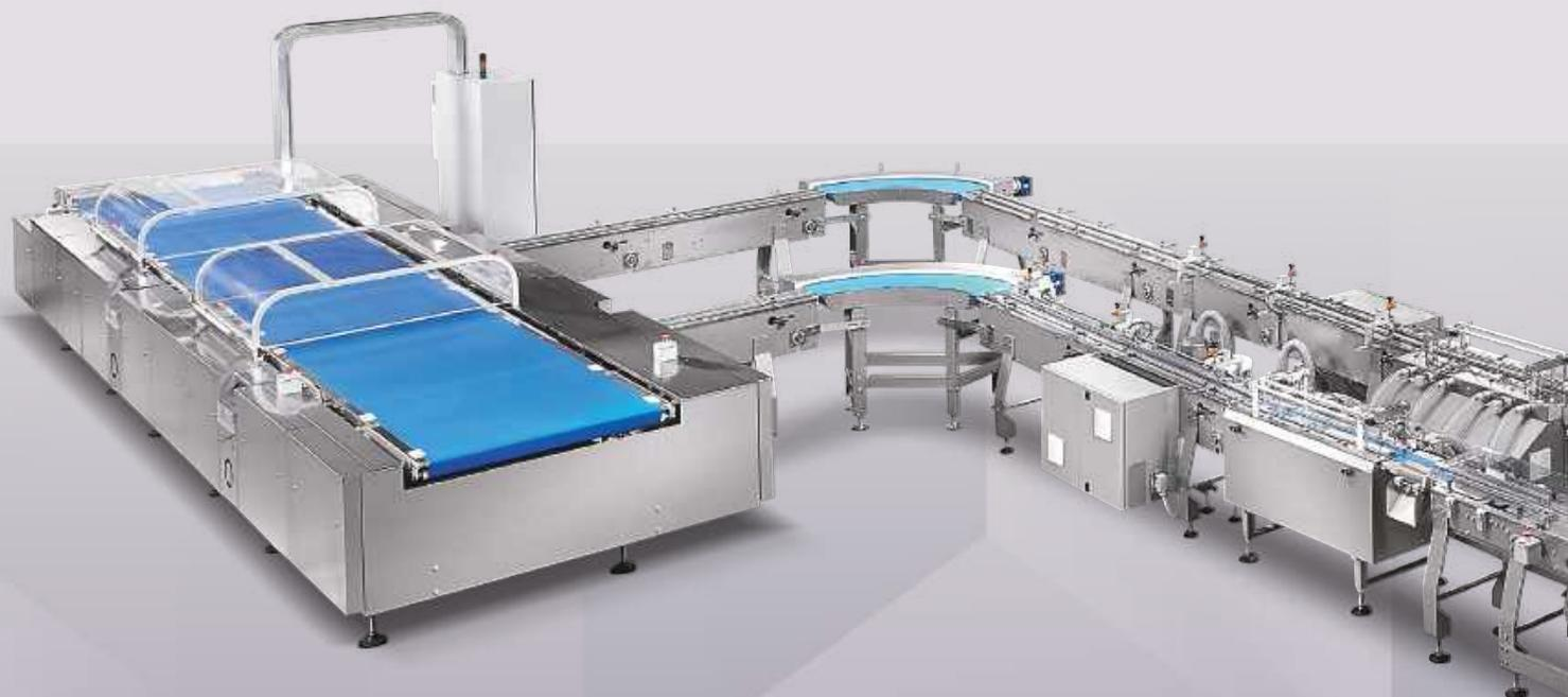
Sistema di distribuzione delle file abbinato a caricatore numerico elettronico per biscotti in costa
