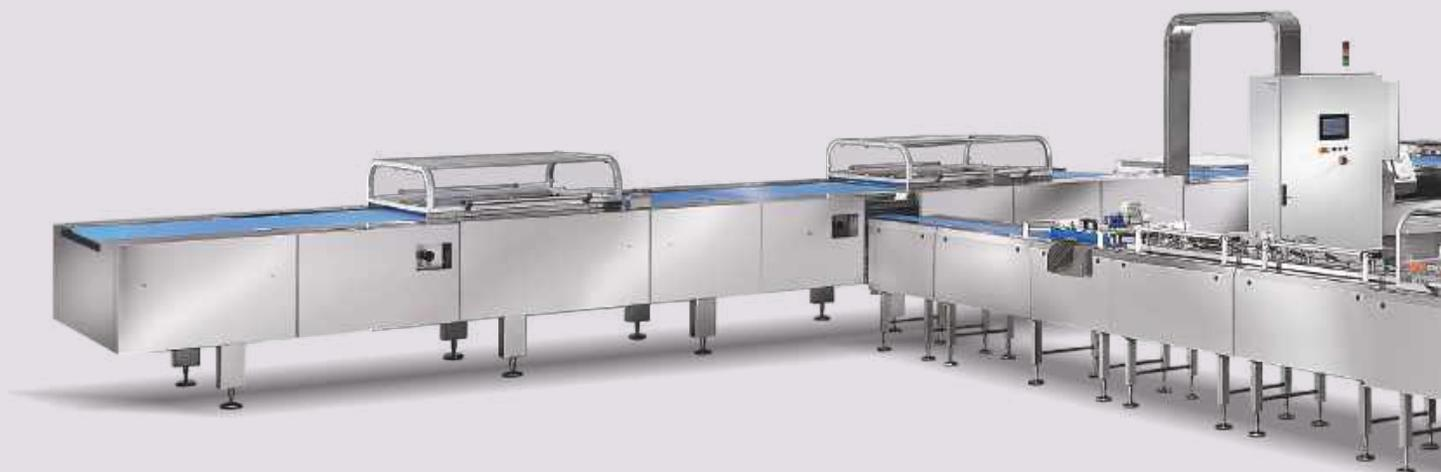
Sistema completamente automatico, progettato appositamente per barrette che arrivano in file allineate e regolari
