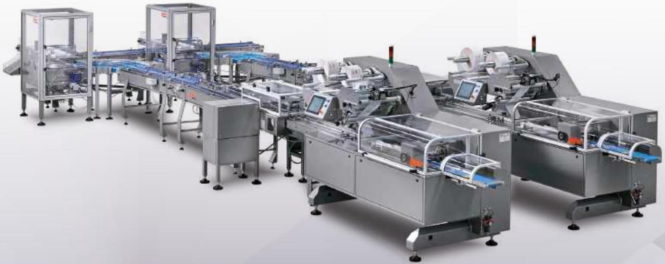
Sistema di alimentazione e porzionatura adatto ai wafer
